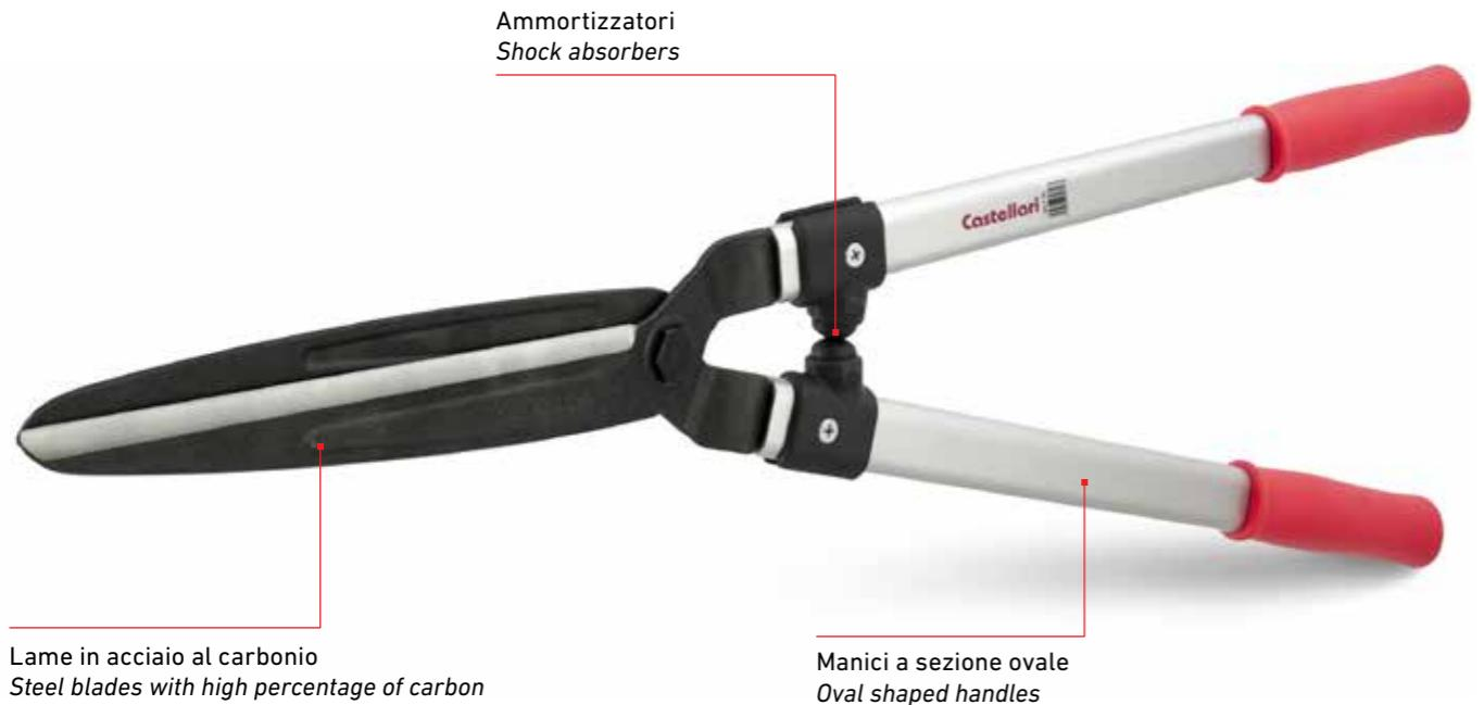
Forbice tagliasiepe professionale con lame in acciaio ad alta percentuale di carbonio. Gli **ammortizzi** centrali eliminano completamente le vibrazioni sulle braccia dell'utilizzatore. I manici del FORBICIONE sono in **alluminio estruso a sezione ovale** in grado di sopportare grandi tensioni pur rimanendo uno strumento leggero. Come tutti gli utensili per potatura manuale Castellari, anche il FORBICIONE, è **completamente intercambiabile**.
