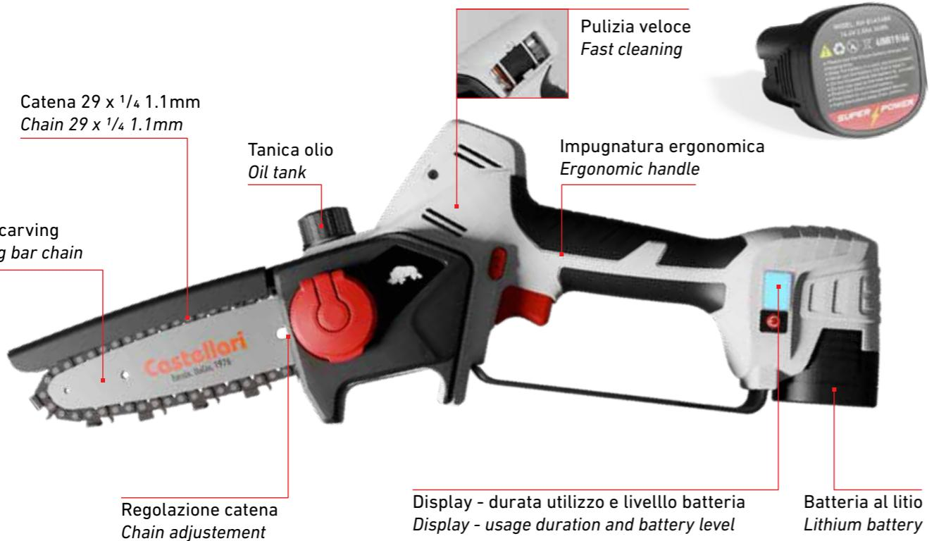
**RY100** è una potatore elettrico con **batteria al litio**. Utile e maneggevole, **grazie al motore da 500W** consente di potare rami **fino a 80 mm**. La **lubrificazione automatica**, mantiene sempre oliata la catena e la barra carving agevola la potatura nelle chiome più folte. Il **pratico sportello** consente di accedere direttamente al vano **motore** per una rapida pulizia.
